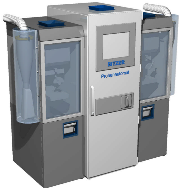
Abbildung 5: Designstudie des Probenautomaten mit zweiter Besatzlinie (Bitzer)
