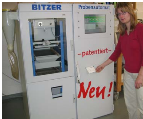
Abb. 2: BITZER Probenautomat: Automatischer Abdruck der ermittelten Qualitäten
