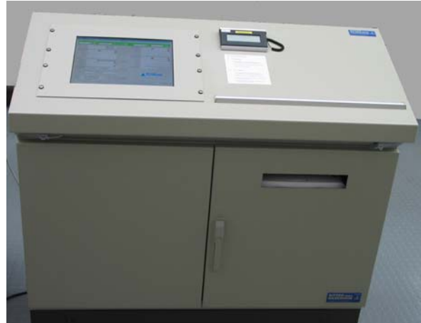
Abb. 9: Selbstbedienterminal mit elektronischem Unterschriften-Pad und Lieferscheindrucker
