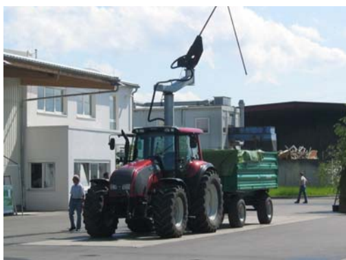
Abb. 6: BITZER Fahrzeugwaage mit automatischer Probennahme
