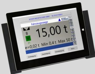
Die mit moderner Hardware und Software entsprechend „Industrie 4.0“ ausgestattete BITZER Touchwaage digitalisiert die analoge DMS-Technik der geeichten Wägezellen und integriert die Waage in ein Netzwerk.
