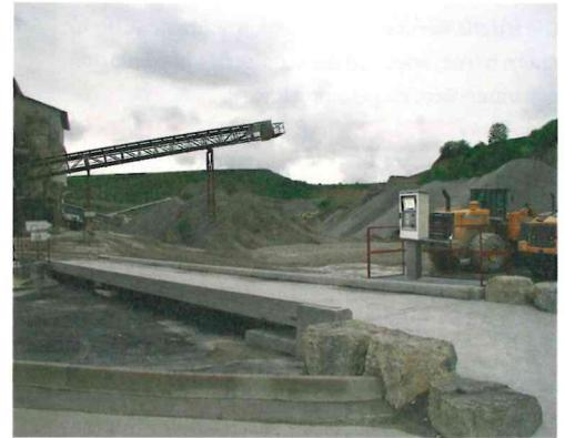
Fahrzeugwaage mit Selbstbedienterminal.
