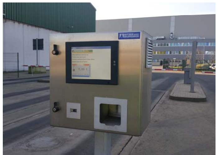
Abb. 9: Waagenterminal zur Erstverwiegung
